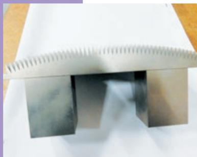
導入機械による試作ノズル
